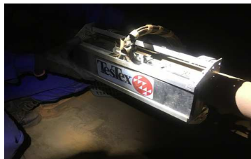
探傷状況 (3Bヒーティングコイル)
